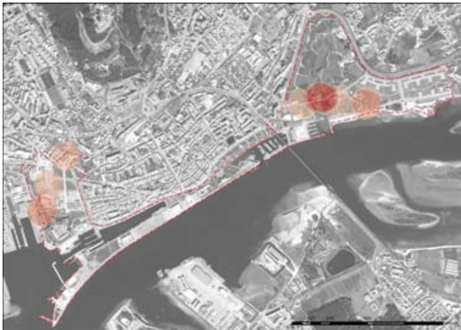
Figura 6 - Estado de conservação do edificado 2017. Análise da densidade das ocorrências, tomando em consideração os edifícios dos níveis 2 e 3. Fonte: CMVC.
